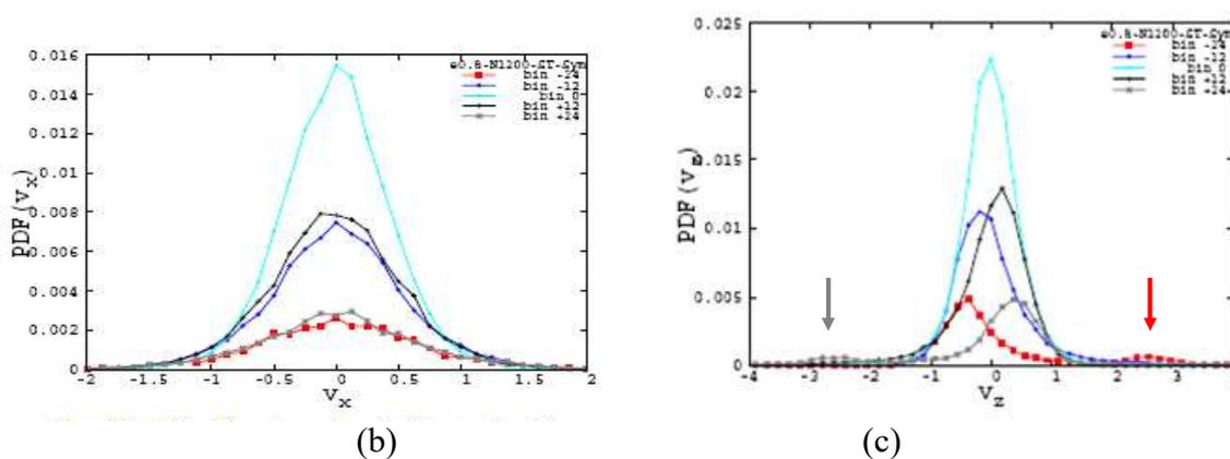
Figures (b) et (c). Résultats des simulations numériques pour une excitation en dents de scie symétrique pour  $N=1200$  billes dans une boîte vibrée parallélépipédique de dimensions  $(L=60d) \times (h=20d) \times (e=20d)$ , avec  $d=1$ (ua) et un coefficient de restitution normal  $\varepsilon=0.8$  pour les collisions bille-bille.
