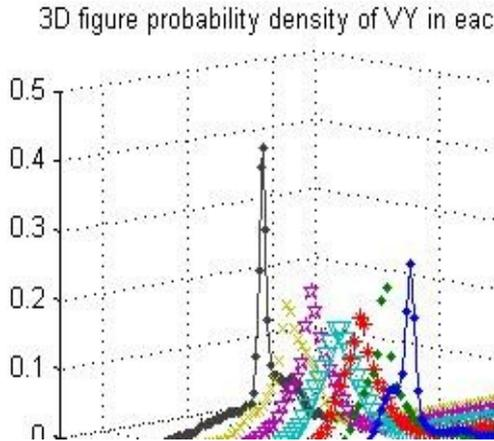
Distribution des vitesses (ici l'axe  $Oy$  correspond à la direction des vibrations).
