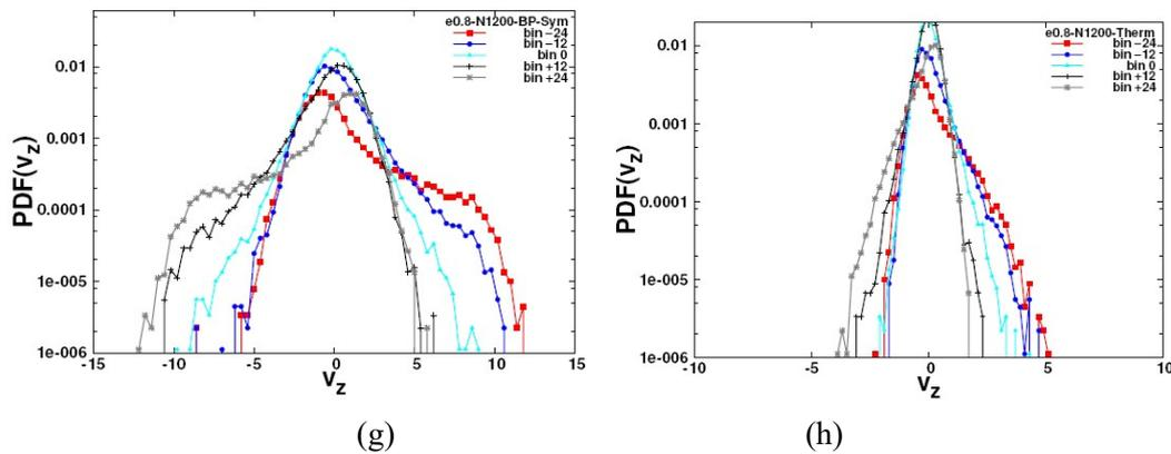
**Figure (g) et (h) sur l'influence de la forme d'excitation, i.e. excitation sinus et thermique, sur la distribution des vitesse  $V_z$ .**
