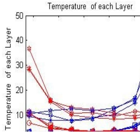
Distribution des températures  $T^+$  et  $T^-$  différents pour 4 paramètres d'excitation sinusoïdale
